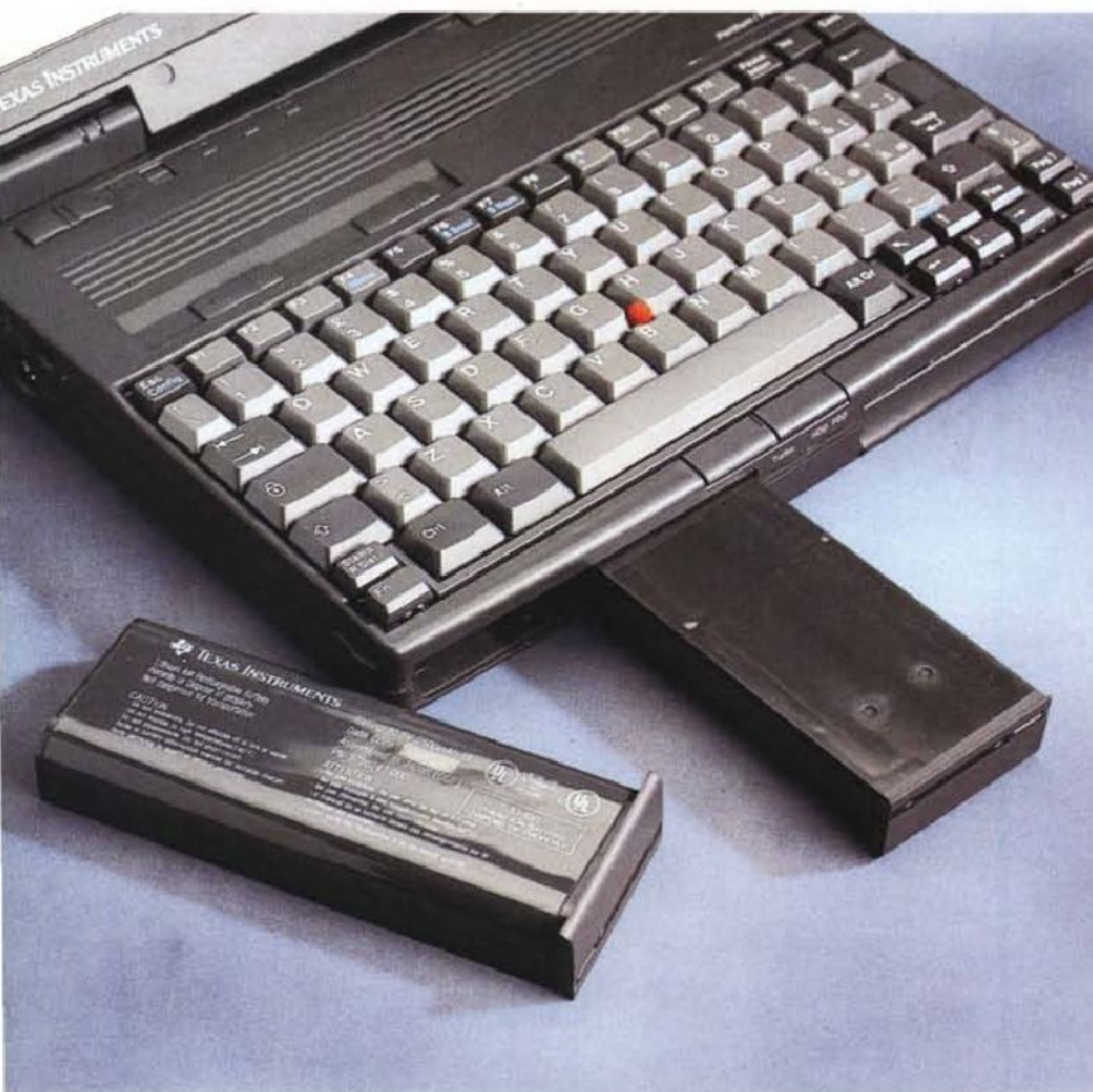
A fianco particolare dello slider della luminosità. Le batterie riservano una vera novità: una piccola scala a led che indica anche con la batteria estratta la quantità di carica.
